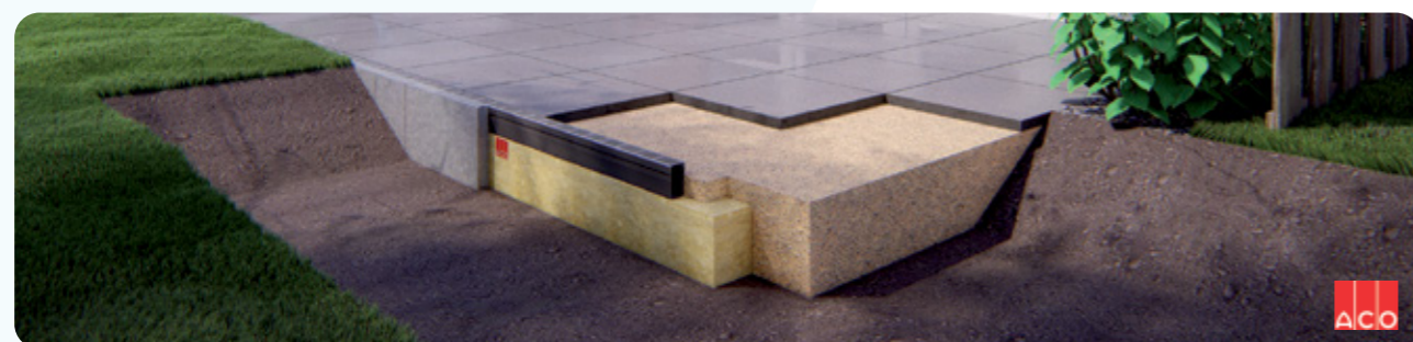
Infiltreren onder een lijngoot
