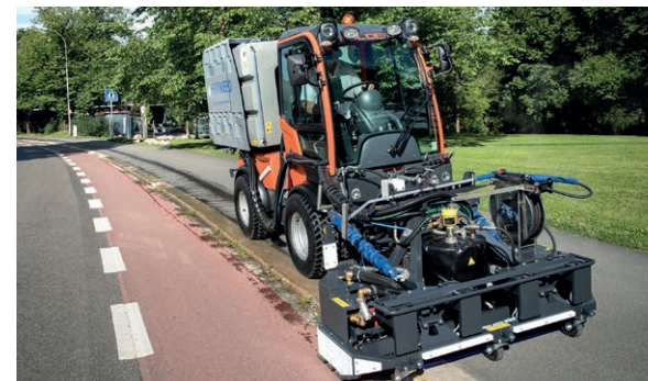
Figuur 24: Onkruidbestrijding d.m.v. heet hemelwater.
